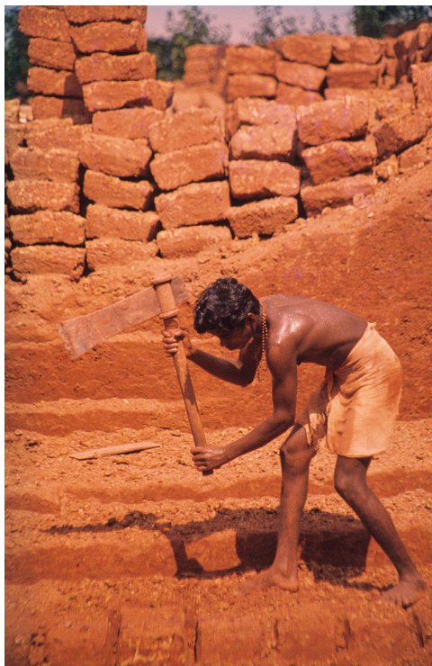
Preparazione di blocchi di laterite da usare come materiale da costruzione, India.
